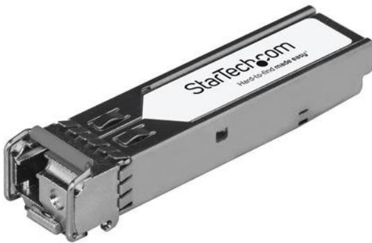
El modelo 10057-ST es un transceptor SFP upstream por fibra óptica compatible con el modelo 10057 de Extreme Networks, que se puede emparejar con 10056H-ST de StarTech.com. Ha sido diseñado, programado y probado para su funcionamiento con routers y switches MSA compatibles con 1000Base-BX. El módulo transceptor SFP+ admite una distancia máxima de hasta 10 km y conectividad confiable a 1 GbE a través de cableado de fibra óptica.
